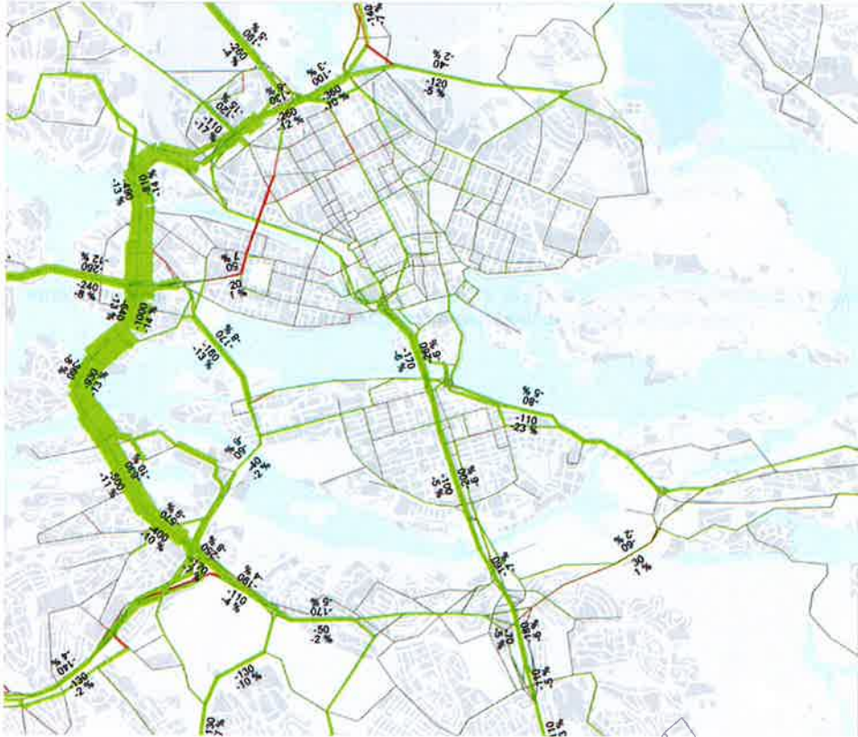
Figur 7-6. Trafikförändring under morgonen i scenario C jämfört med utgångsläget. Grönt = trafikminskning, rött = trafikökning. Siffrorna avser fordon/timme år 2020. Absolut och relativ förändring.
