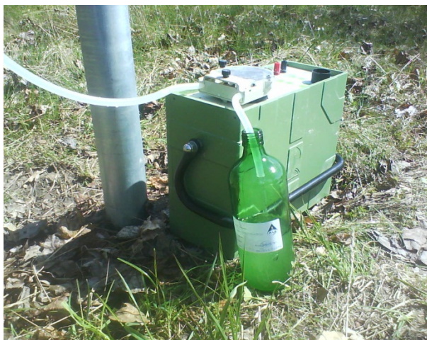
Figur 2. Provtagningsutrustning för provtagningen i nivå rör, i nivå rör under däcksel (till vänster), i den vanligaste typen av nivå rör (till höger) och i miljörör (nedan).
