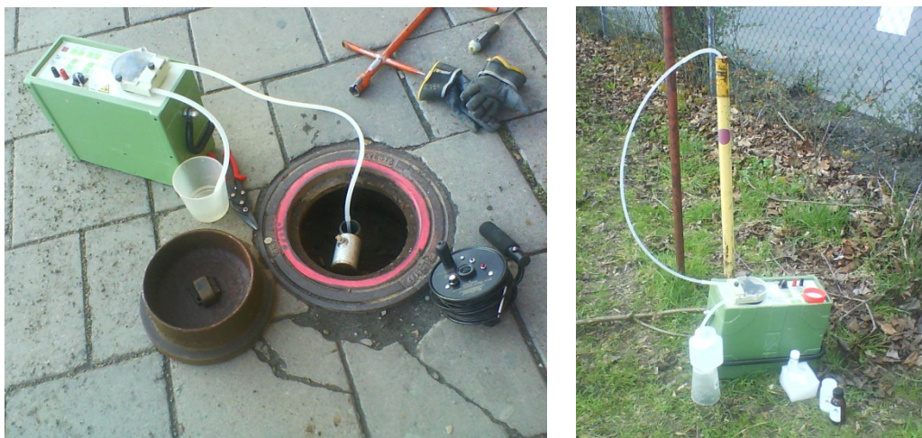
Figur 2. Provtagningsutrustning för provtagningen i nivå rör, i nivå rör under däcksel (till vänster), i den vanligaste typen av nivå rör (till höger) och i miljörör (nedan).
