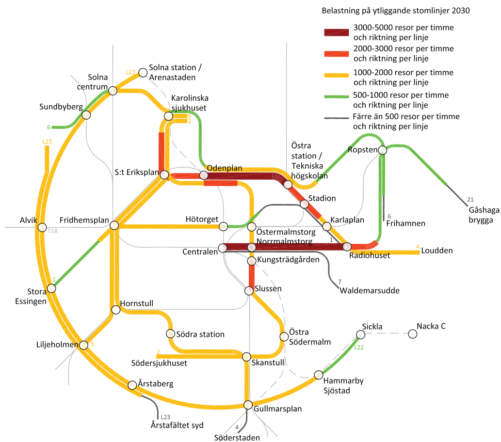
Figur 17. Figuren visar belastningen under maxtimmen i den dimensionerande riktningen på föreslaget stomnät år 2030, exklusive pendeltåg och tunnelbana. Antagen medelhastighet är 20 km/h.x
