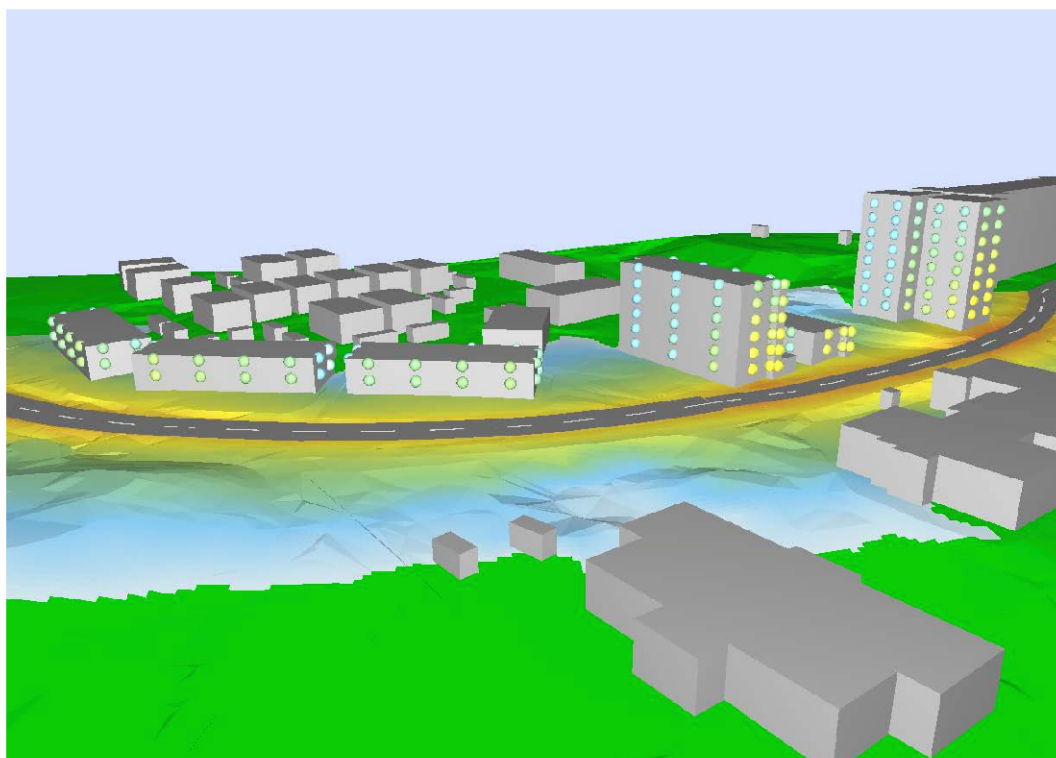
Figur 8. Tredimensionell återgivning av de beräknade ekvivalenta ljudnivåerna i nulägesituationen. Vy från söder.
