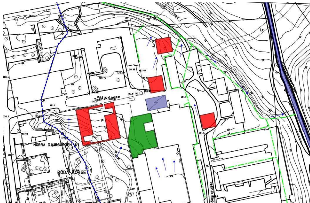
Figur 5. Planskiss över utredningsområdet. De studentbostäder som tillkommer är markerade i rött, Operahögskolans utbyggnad i grönt och elstationen markerad i blått kommer att rivas. Blått streck visar läge för ungefärlig vattendelare och grön linje är ungefärligt läge för befintliga dagvattenledningar. Pilarna visar områden där marken sluttar mot den nya bebyggelsen.
