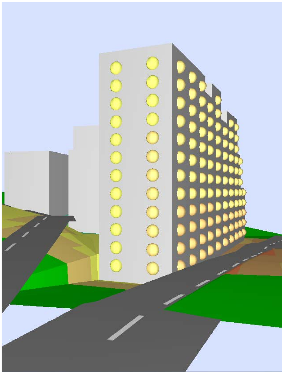
Figur 2: Huset närmast Värtavägen sett från sydost. Gul och orange färg visar nivåer över 55 dB(A). Grön färg visar nivåer under 55 dB(A).
