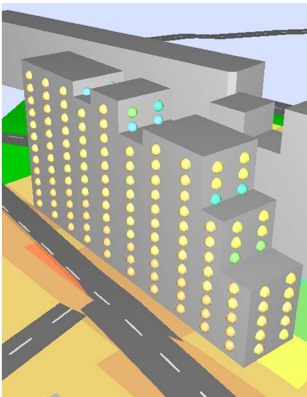
Figur 1: Huset närmast Värtavägen sett från nordost. Gul och orange färg visar nivåer över 55 dB(A). Grön färg visar nivåer under 55 dB(A).
