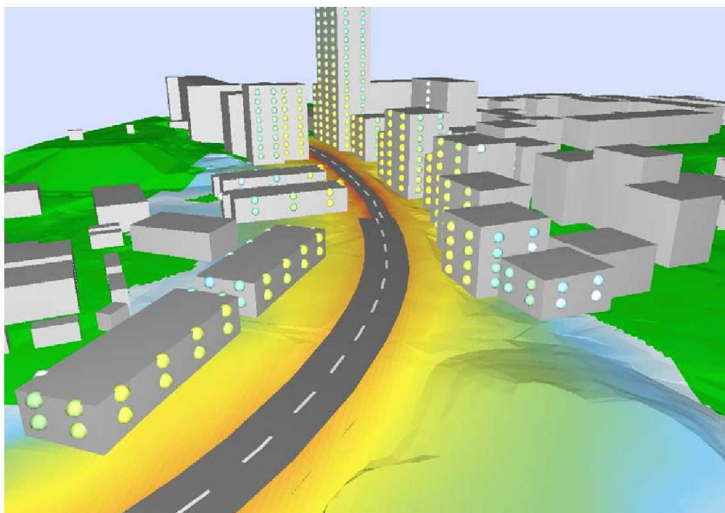
Figur 10. Tredimensionell återgivning av de beräknade ekvivalenta ljudnivåerna i utbyggnadsförslaget. Vy från väster.
