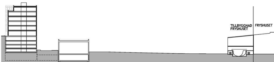
Sektion B-B genom hela planområdet med skärning genom kontorshuset mot Hammarbybacken (till vänster), transformatorstationen och ny skatehall (till höder).
