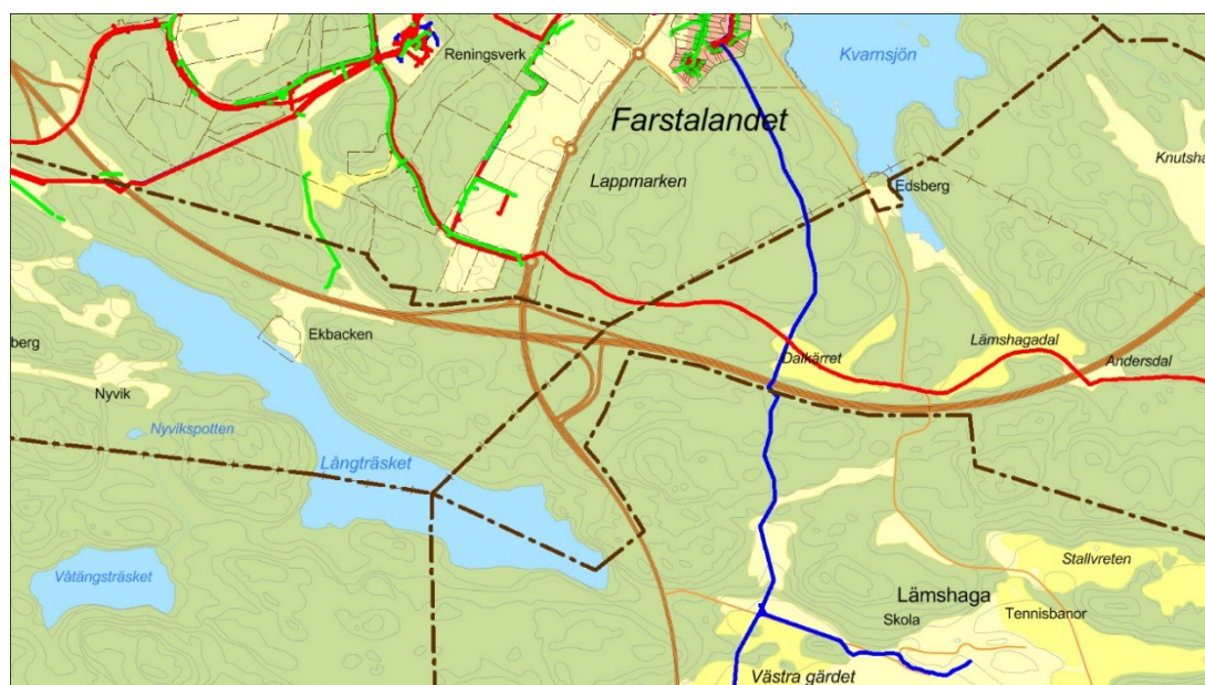
Blå linje illustrerar vattenledning, röd linje avlopp och grön dagvatten.
