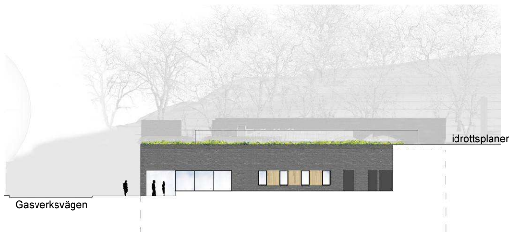
Fasad mot sydväst på idrottshallen. Entré sker från Gasverksvägen. Idrottshallens tak ansluter till idrottsplanernas nivå. Den streckade linjen visar byggnadens utbredning under mark där hallens golv ligger nedsänkt. Bild: AIX Arkitekter.
