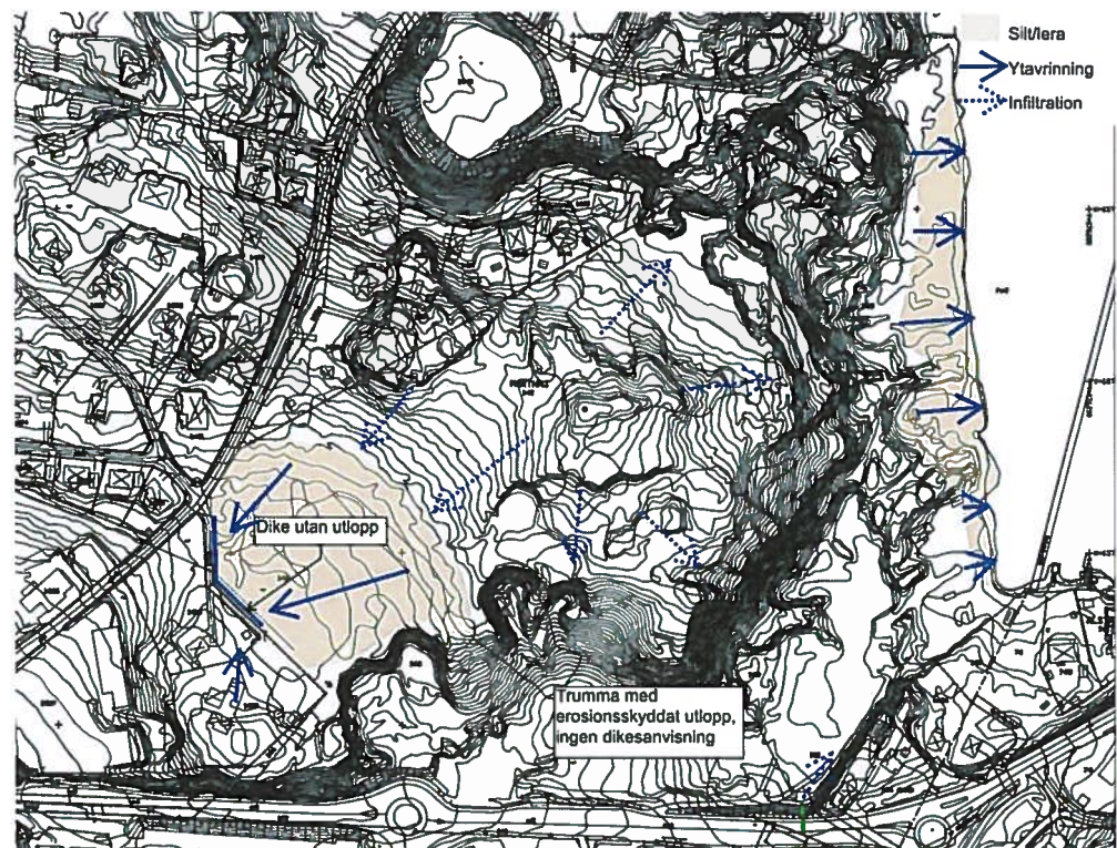
Figur 5 Nuvarande dagvattenflöden inom planområdet.
