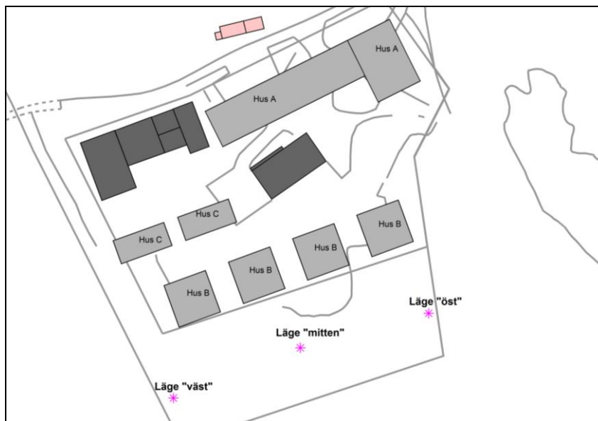
Figur 19. Hantering av schaktmassor i tre olika lägen Mörkgrå huskroppar är befintliga, och ljusgrå är planerade.
