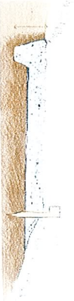
Principritning över grusad stig med ledmarkering för synskadade i form av stoppträda i ena kanten.
