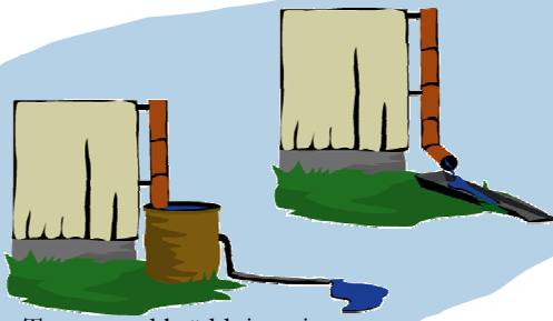
Tunna med bräddning via slang
