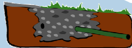
Ett bättre sätt... ..vatten leds på markytan fram till ”stenkistan” som även bör ha tömning via dränering...
