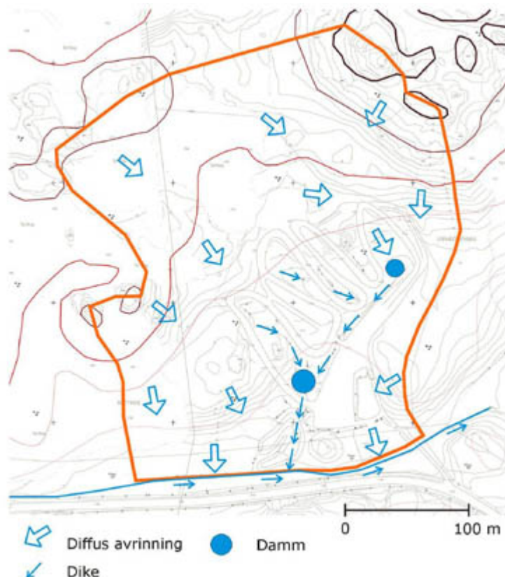
Figur 7. Nuvarande avrinningsvägar för ytvatten från fastigheten. Orange linje utgör avrinningsområdesgräns. Figuren är tagen från dagvattenutredningen (WRS 2011).
