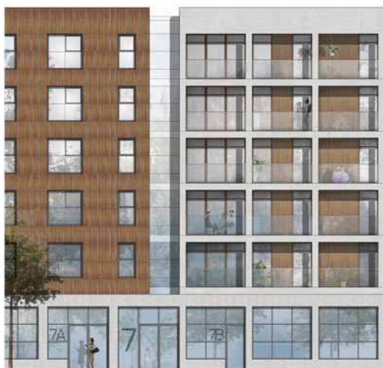
BILD 4:6:3 Fasadutsnitt. Utsnitt av Hus 1 och Hus 2 på den gemensamma sockeln i ljus tegel. En glasslits skiljer volymerna åt, materialen växlar och länkar dem samman. Cortenstål och betong kopplar till områdets industriella karaktär medan detaljerna står för något nytt, den inre fasaden kläs med träribbor för en varmare närmiljö, glasträcket spänns in mellan pelarna utan synligt bärverk.
