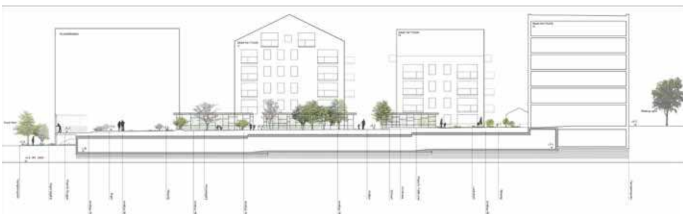
BILD 5:1:4 Sektionssnitt genom kvarteret och gården, till vänster Husarviksgatan, till höger Bobergsgatan.
