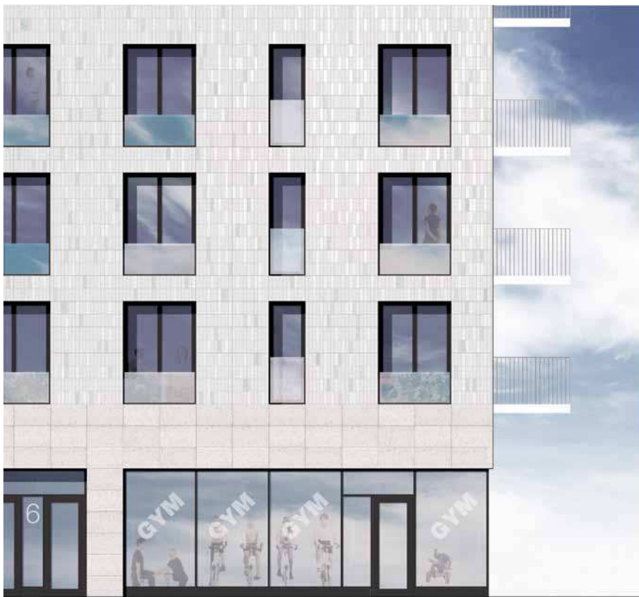
BILD 4:2:4 Gathuset's fasad är uppbyggd av ett rutnät där natursten, fönstersättning och fasadbearbetning samspelar.
