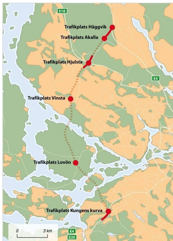
Figur 5. Förbifartens sträckning. Den streckade linjen markerar de delar av vägen som ska gå i tunnel. (Källa: www.trafikverket.se )
