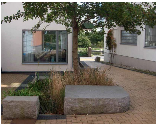
Växtbädd för hantering av innergårds dagvatten (Okidoki).
