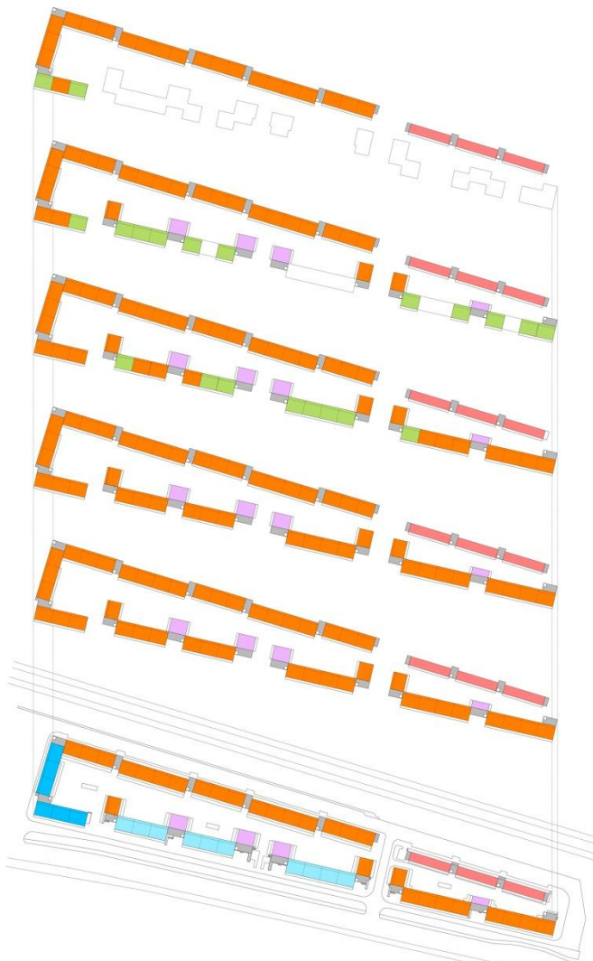
Schematisk bild som visar placering av de fyra lägenhetstyperna i byggnaderna. Lokaler och gemensamma ytor är markerade med blått.
