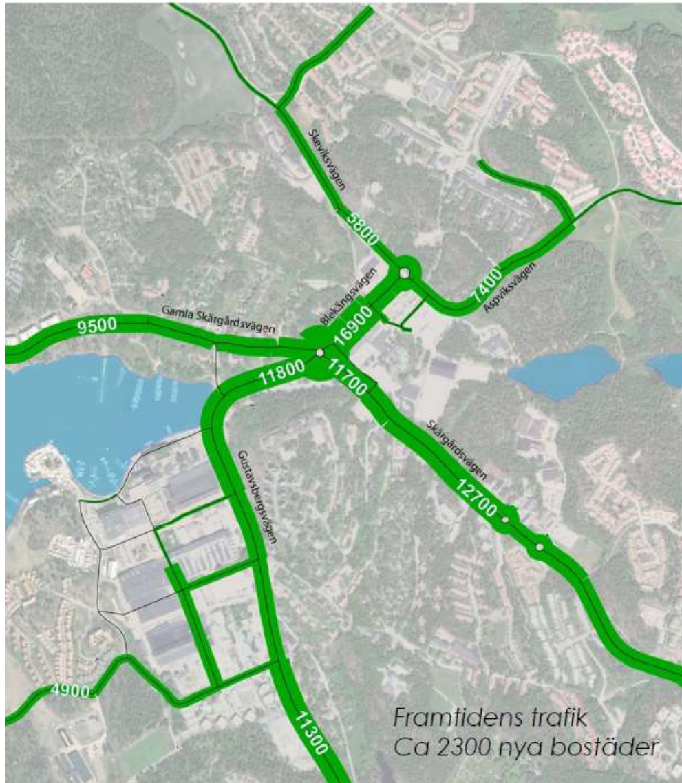
Bild 11: Dygns trafikens fördelning vid ett fullt utbyggt Gustavsberg och med en länk över Ekobacken (Tyréns 111124)
