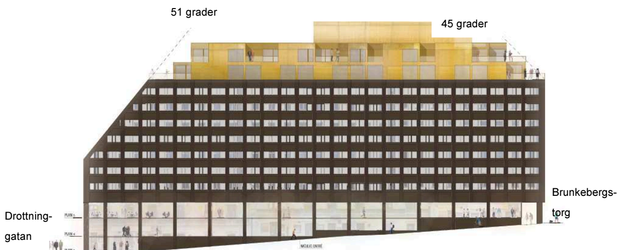
Fasaden mot Vattugatan med den föreslagna påbyggnaden av hotellet med två hotellvåningar och en mindre teknikvåning. (Wingårdh Arkitektkontor)
