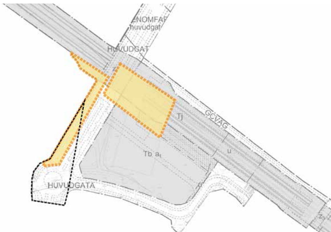
Figur 9.4. Figur som visar Mäljarbanan (D 120712) samt föreslagna planändringar. Streckad svart linje betecknar område som föreslås omfattas av schaktdjupsbestämmelse. Gula områden med streckad orange kantlinje betecknar område som utreds för ytanläggningar. Schaktdjupsbestämmelser kommer även att tillkomma utanför området markerat med streckad svart linje, utbredning framgår av järnvägsplanens ritningar.
