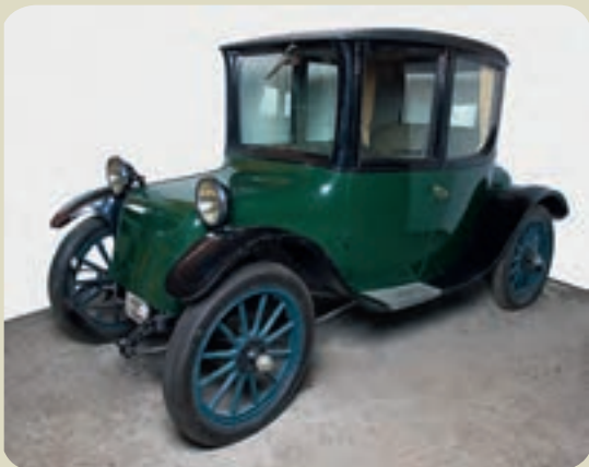
En av elbilarna i Tekniska Museet i Stockholms samlingar. T-Ford från år 1919. General Electric elmotor, effekt 4,5 hk, 80 volt batterispänning, högsta fart cirka 35 km/h och körsträcka 4–5 mil.
