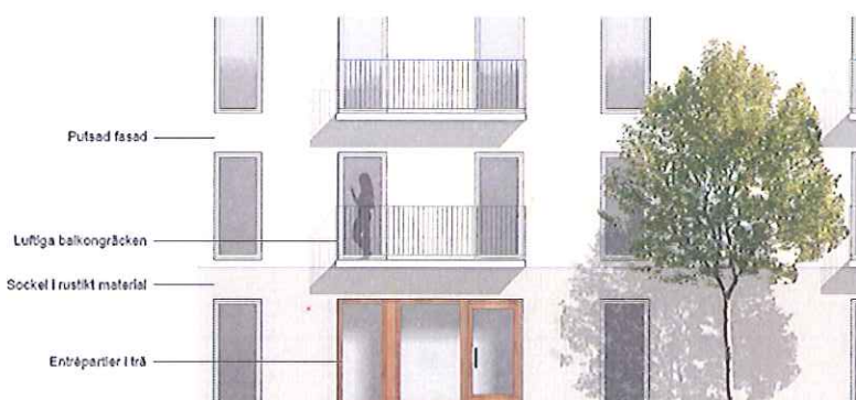
Fasad-, balkong- och entrédetaljer (hus 1 och hus 2)
