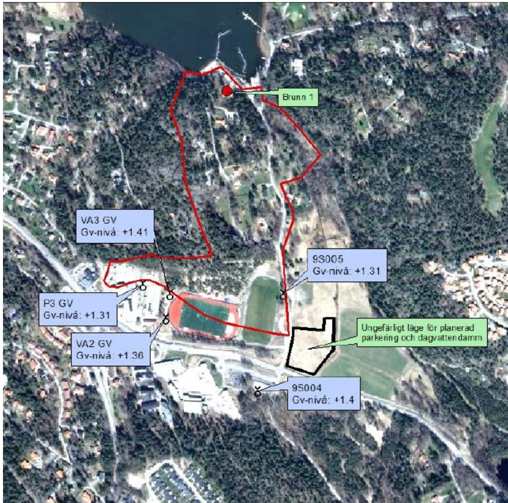
Bild 8. Översikt över området med grundvattenrör, högsta nivåer och Brunn 1. Röd linje utgör avgränsning mellan primär och sekundär skyddszon
