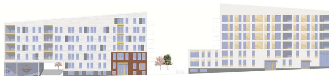
Elevation utmed Tellusgatan. Takens lutning kopplar ihop de två kvarteren visuellt. Bottenvåningarna varierar dels inom kvarteret dels mellan de två delarna för att bidra och skapa variation i gaturummet. Lokaler finns i strategiska kvartershörn och ska till stor del vara glasade. Illustration: Rosenbergs arkitekter
