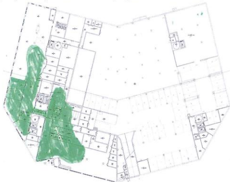
Ungefärlig utbredning av vattenskador i källarplan (i huvudsak skolans lokaler).
