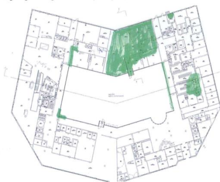
Ungefärlig utbredning av vattenskador på entréplan (servicehus och förskolans lokaler).
