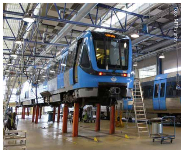
Speciella lyftar i verkstaden används för att komma åt under tunnelbanetågen både vid reparationer och underhåll.
