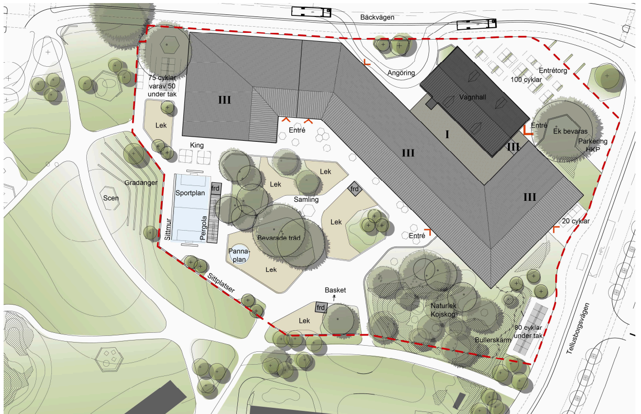
Situationsplan över den nya skolan och skolgården. Röd streckad linje illustrerar skolans nya fastighetsgräns. Illustration Liljewall arkitekter
