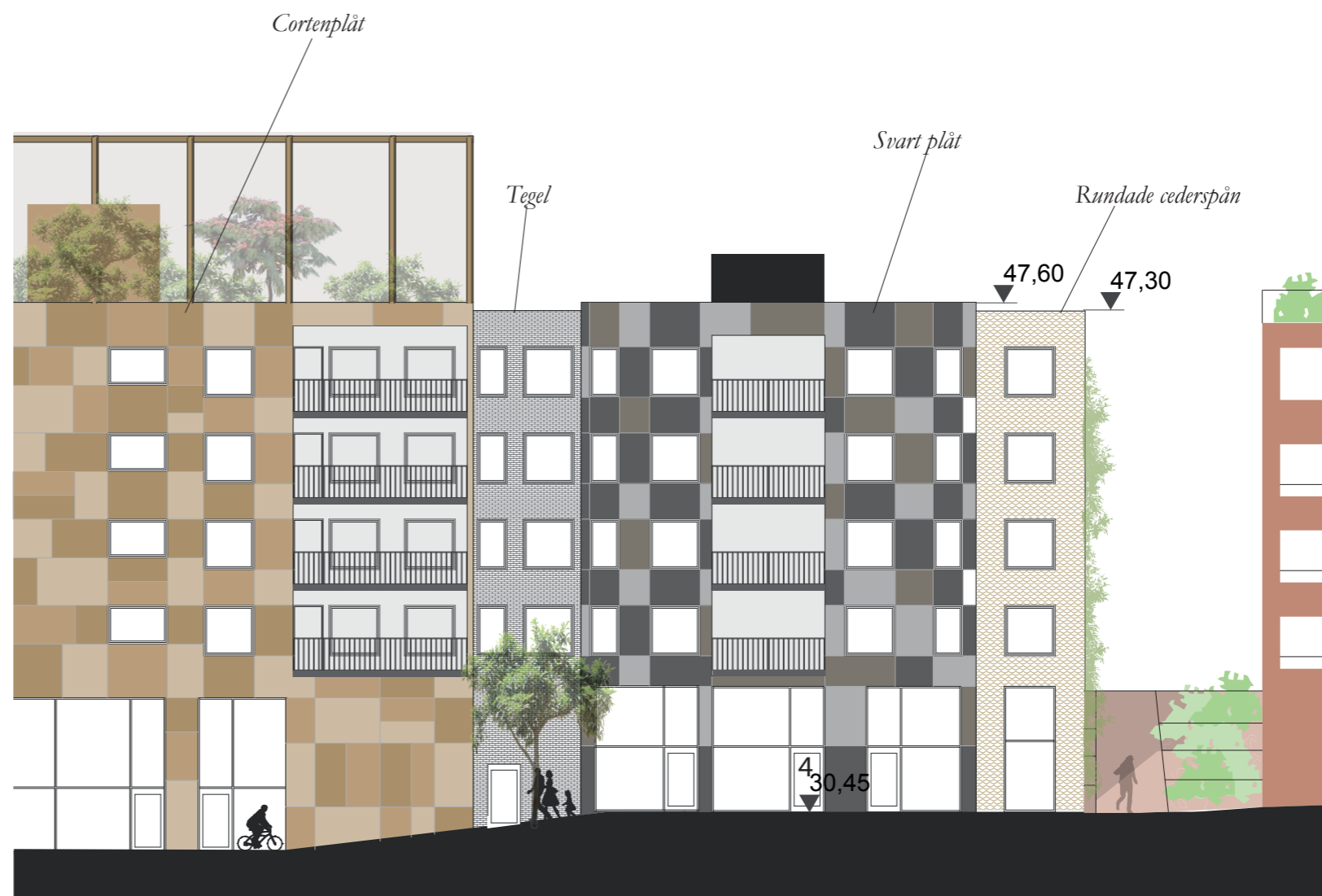
Typsektion 1:200 Växtvägg mot Tvärgatan
