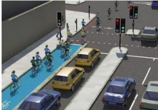
Figur 31. En korsningstyp som provas inom projektet. Cyklisterna har samma grönfas som trafik rakt fram, men skild från vänstersvängsfasen.
