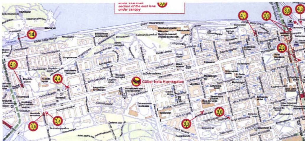
Figur 1. Karta över Hornsgatan, inklusive fri höjd i vägportar för tung trafik år 2010. Källa: Stockholms stad 2011a.
