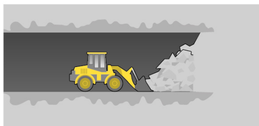
Löst berg knackas och bryts bort från bergytan, som förstärks vid behov med sprutbetong och bultar. Massorna efter det sprängda berget schaktas undan och transporteras ut ur tunneln.
