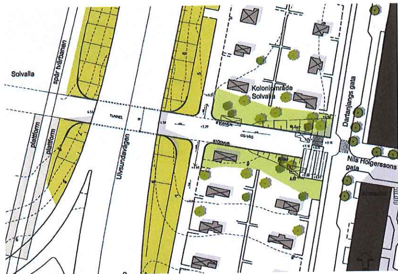
Möjlig sträckning och utformning av förbindelse, Structor
