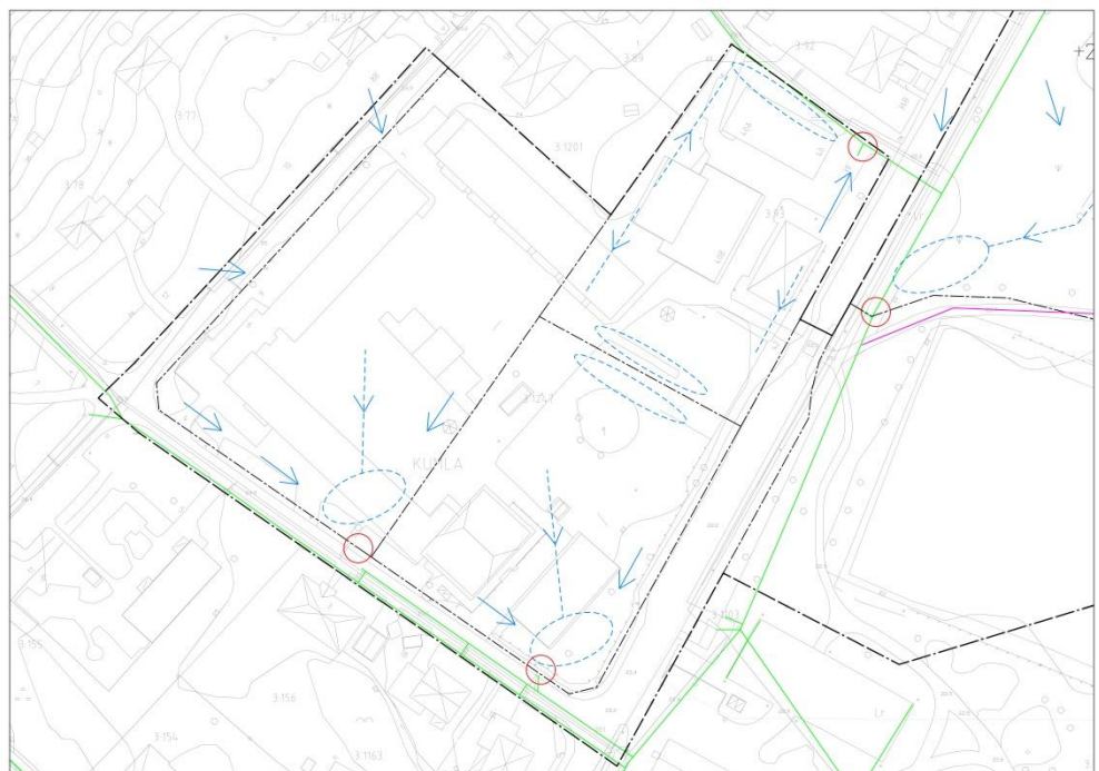
Figur 10. Systemlösning för västra delen. Streckade linjer visar lågpunktslinjer och översvämningssytor, heldragen pil avrinningsriktning och röd ring anslutningspunkt.
