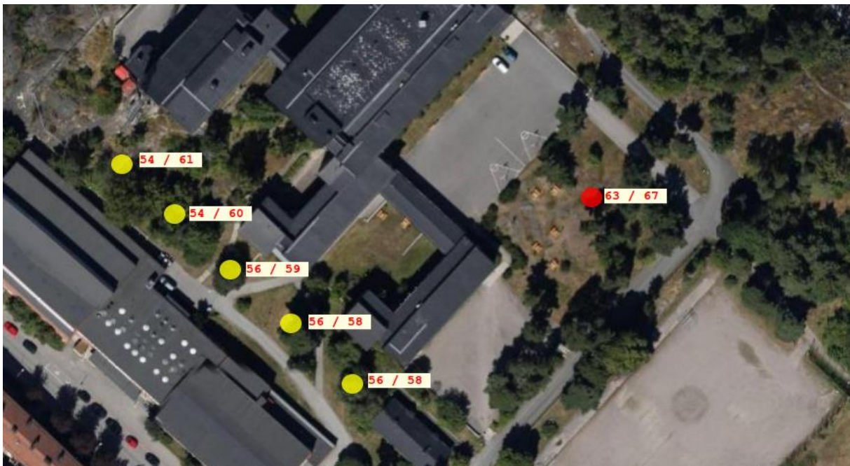
Figur 2: Dygnskvivalent trafikbuller dBAeq på 1,5 och 5 meters höjd över mark.
