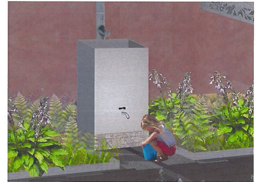
14. REGNSKÖRDARTUNNA ANPASSADE FÖR FLERFAMILJSBOSTÄDER. DET BRÄDDADE TAKVATTNET FÖRDRÖJS OCH GÖRS TILLGÄNGLIGT FÖR PLASKLEKAR OCH BEVATTNING. STUPRÄNNAN SOM FILLER TUNNAN MED REGNVATTEN KAN STÄLLAS OM SÅ ATT TAKVATTNET VID KALLARE TIDER, DÅ TUNNAN SKA VARA TÖMD, LEDS BORT.
