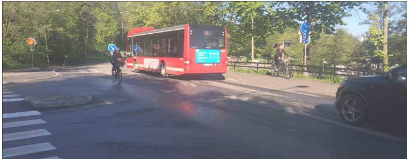
Figur 8. Cyklist i blandtrafik kan passera genom korsningen utan att tappa fart. Cyklist på gång- och cykelbana måste väja för flera trafikströmmar innan korsningen passeras diagonalt.
