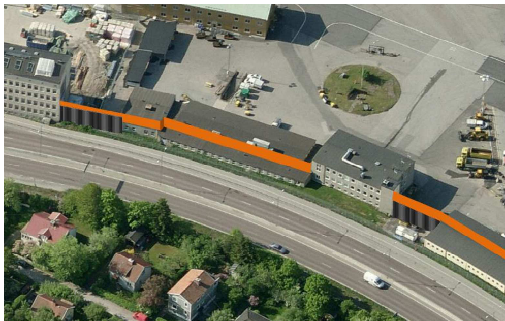
Figur 4. Vy från norr som visar området mellan flygplatsen och Mariehäll. För att reducera ljudnivån 1-2 dB(A) enheter ytterligare skulle en cirka 8 meter hög skärm behöva anläggas.
