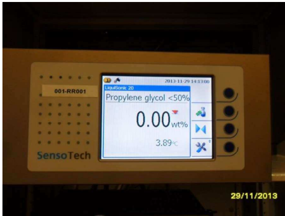
Figur 4.5: Utvärderingsenhet vid Bergen-Flesland, Controller, fabrikat Sensotech. www.sensotech.com
