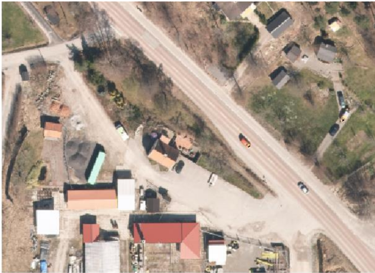
Figur 20. Bilden illustrerar bredd av infart till området idag. Genomförande av föreslagen plan innebär att infartens bredd minskar från 18 till 8 meter. Jämför med figur 17.
