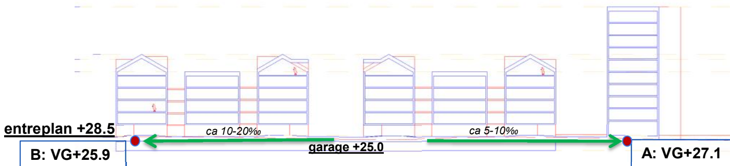
Figur 9. Sektion över planerad bebyggelse. Vattengång för dagvattenserviser inramade. Princip för föreslagen ledningsdragning.
