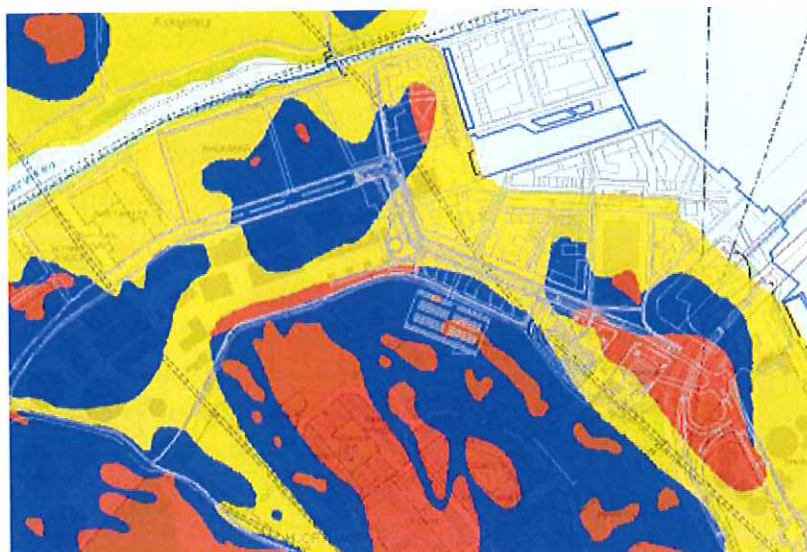
Stadens byggnadsgeologiska karta, ur den geotekniska utredningen. Gult visar lera, blått visar moränjord, rött visar berg vid eller nära markytan. I bakgrunden visas planerad bebyggelse.
