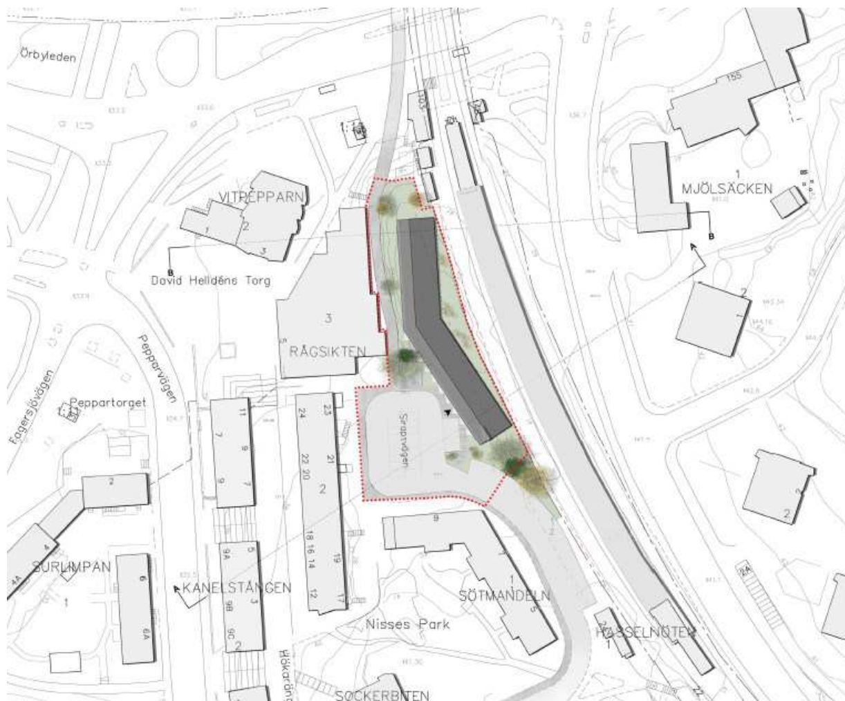
Situationsplan. Det rödmarkerade området är planområdet med den nya byggnaden i mörkgrått och entrébalkonger i ljusare grått. Bild: Arkitektstudio Witte
