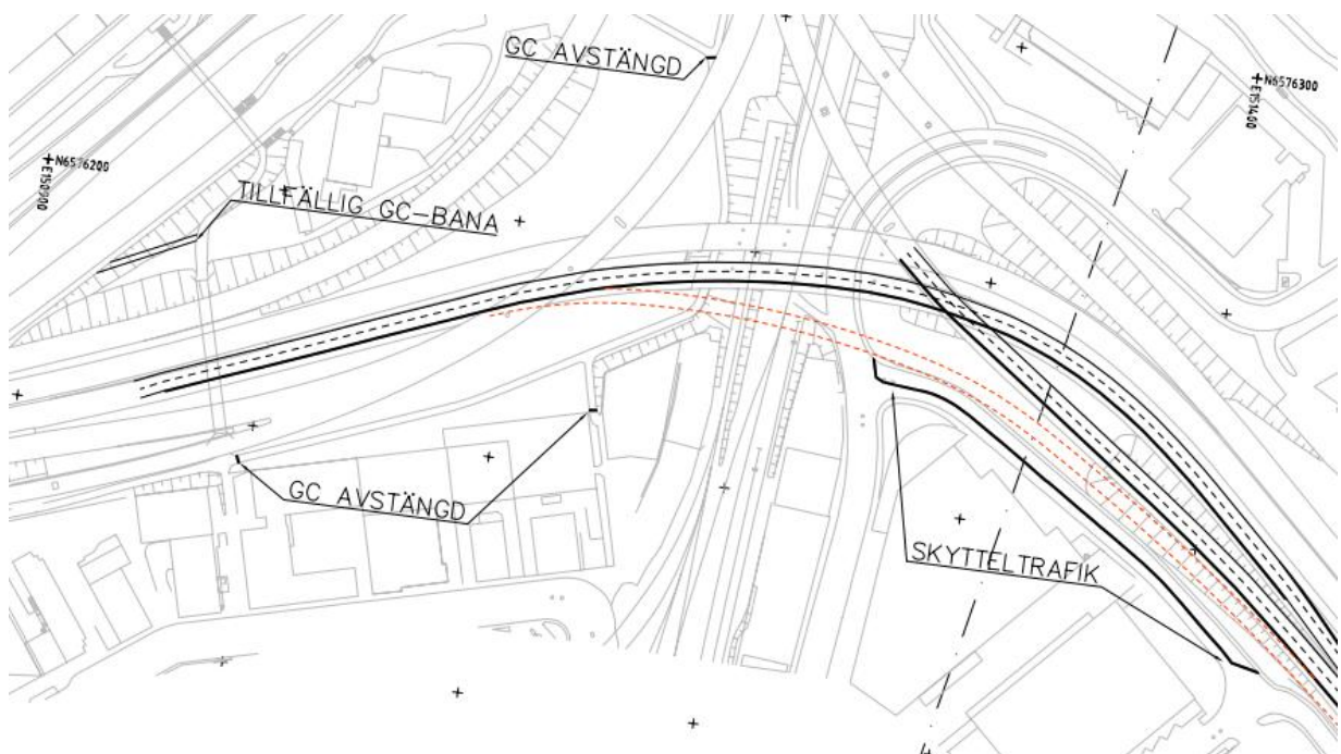
Figur 22 – Byggande av Ramp C. Upplagsvägen måste smalnats av.
