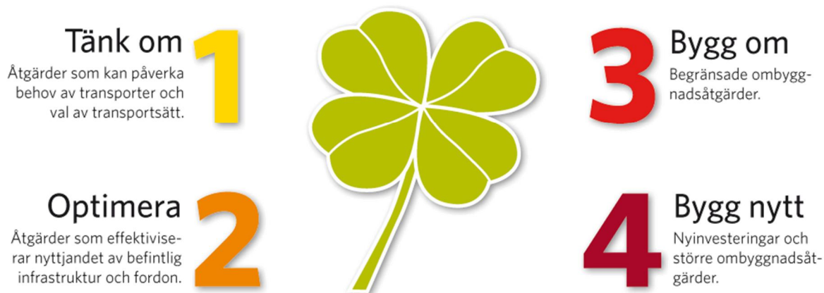
Figur 6 - Beskrivning av fyrstegsprincipen (källa: Trafikverket).
