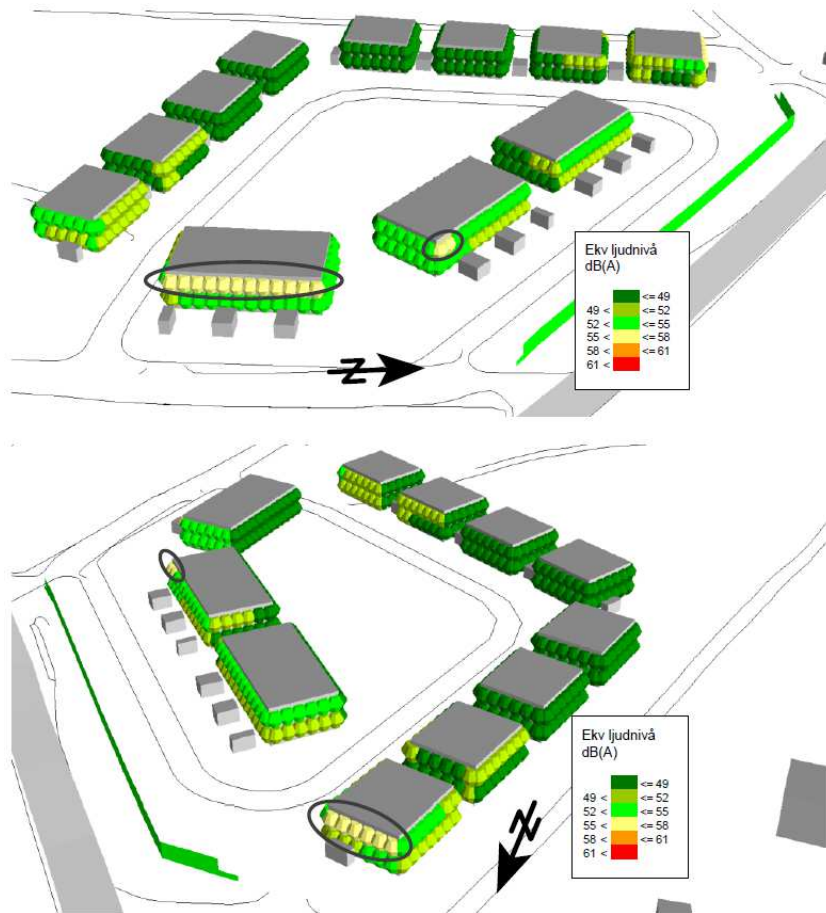
Figur 14. Ekvivalent ljudnivå (frifältsvärde) vid fasad mot väg 274 med 3 meter hög bullervall. Inringade områden visar överskridande av riktvärde 55dBA.
