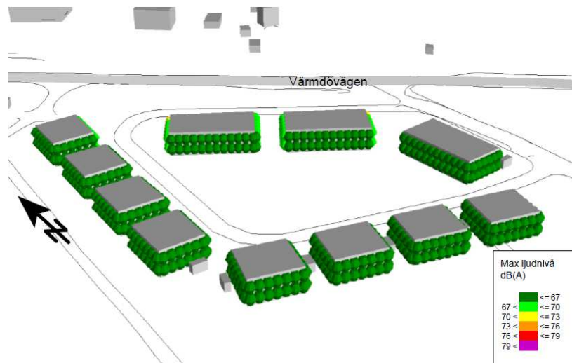
Figur 13. Maximal ljudnivå (frifältsvärde) vid fasad på skyddade sidor bort från Värmdövägen, sett söder ifrån.
