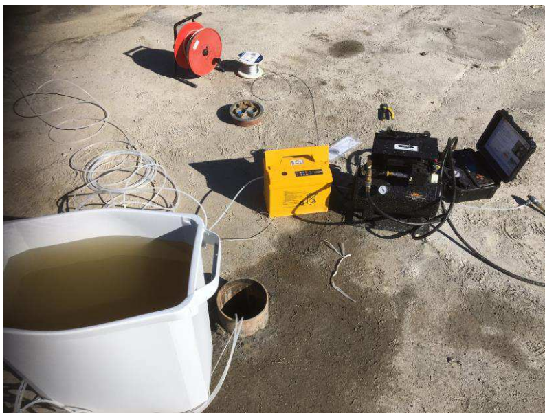
Foto 2. Provtagning med bladderpump vid punkt RGS01
