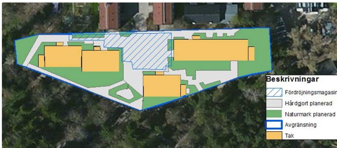
Översiktlig principskiss med ungefärlig placering av fördröjningsmagasin (blåstreckad yta). Det streckade området omfattar en area på cirka 670 kvm. Bild: Geosigma.
