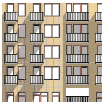
Infärgad betong som bildar horisontellt mönster och döljer elementskarvar. Exempel från kv 6a. Referens "Flat iron building" av Rosenbergs.
