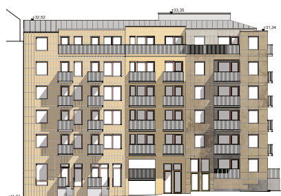
Fasad mot Persikogränd 1:600. Infärgad betong och kakel i mönster döljer elementskarvar.
