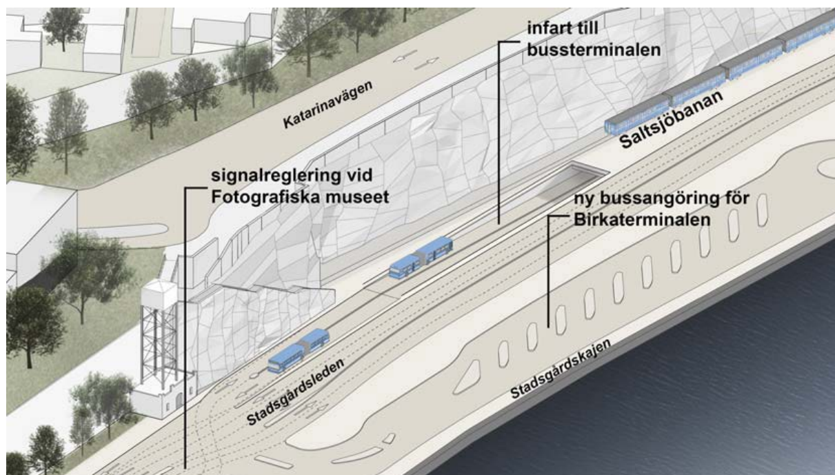
Fig 19. In- och utfart för bussar vid Stadsgårdsleden. Vid en signalreglering på Stadsgårdsleden vid Fotografiska (strax utanför bildens nedre vänstra hörn) växlar inkommande bussar över till nedfarten till bussterminalen. I rampen ner till termi-
