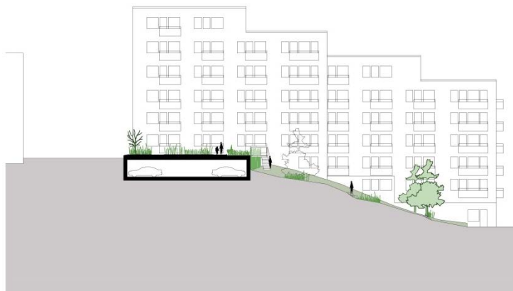
Terrasserade lamellhus med garage. Längdsektion. (Joliark)
